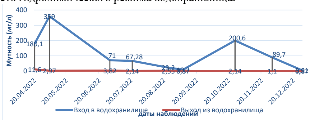
Рис. 4. Изменение количества мутности в воде при входе и выходе из водохранилища
