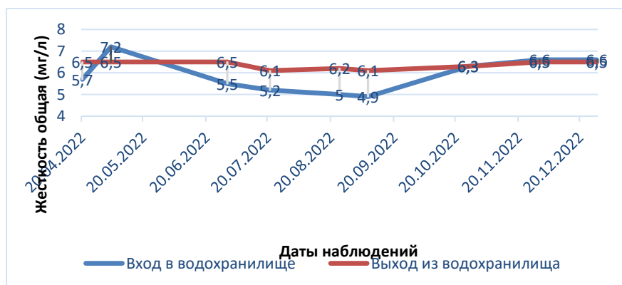
Рис. 2. Изменение общей жесткости воды при входе и выходе из водохранилища
