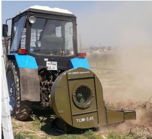
**Рисунок 4 Машина для открывки виноградной лозы воздушным потоком.**
