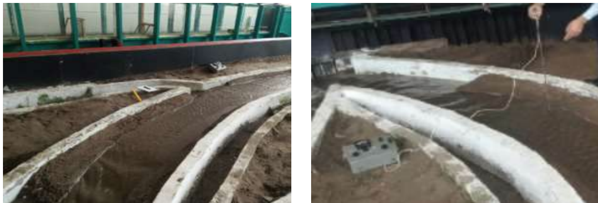
Рис. 10. Установка для экспериментальных исследований по определению размыва русла
