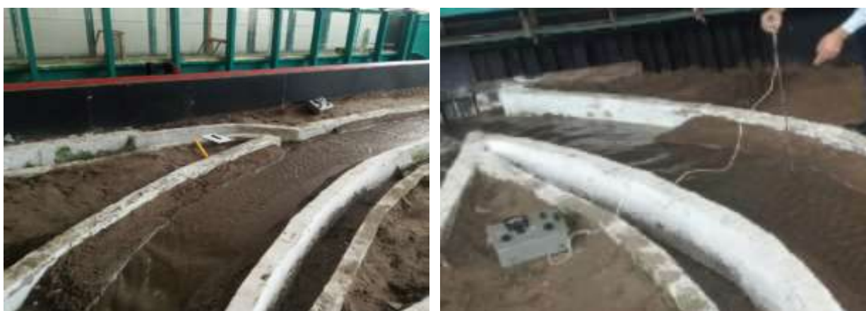
9-расм. Ўзан ювилишини аниқлаш бўйича экспериментал тадқиқотлар қурилмаси
