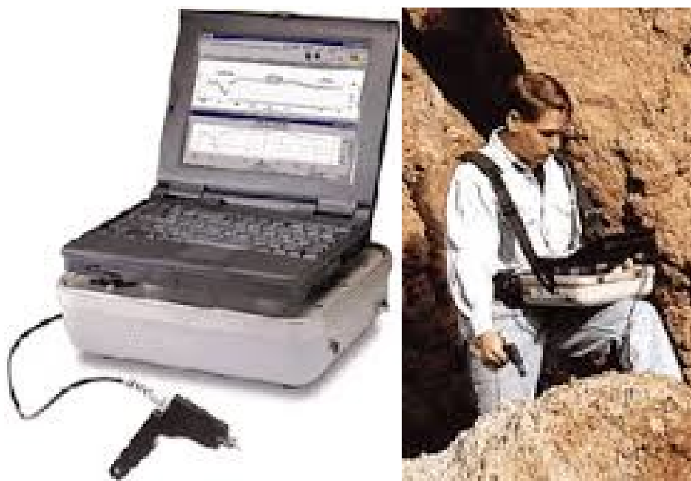
2.22-rasm. Analitik spektrli asboblari FieldSpec FR Spektoradiometr: a) asbob; b) asbob dala sharoitida ishlatilmoqda (Manba: 5 adabiyot).
