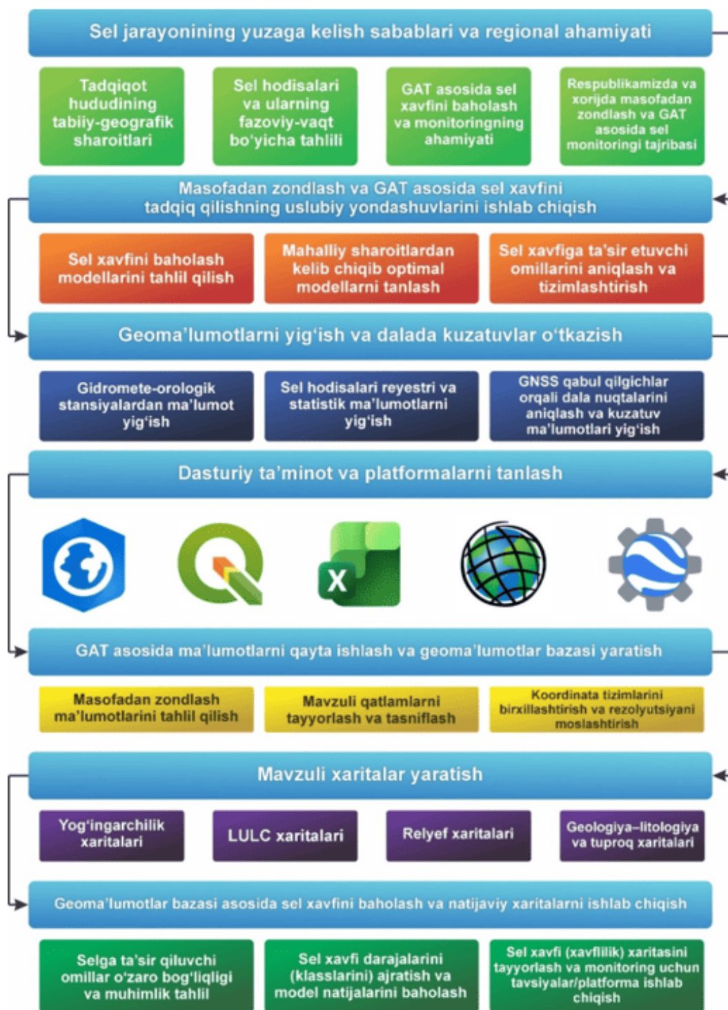
3-rasm. Surxondaryo daryosi havzasida sel hodisalari va ta'sir etuvchi omillar asosida sel xavfini kompleks baholash tizimi
