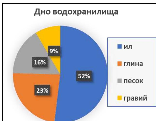
**Рис. 5. Распределение наносов на дне водохранилища Наглу**
