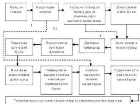
3-rasm. Nasos korpusi resursini tiklash marshrut texnologik jarayonlari
