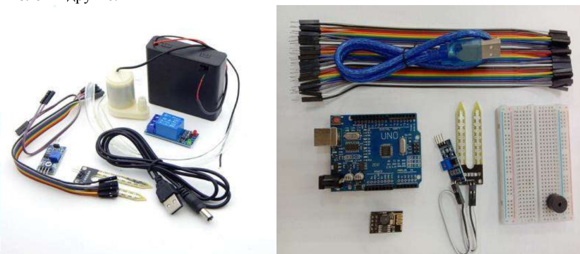
Рис 5. Необходимые компоненты для автоматического полива.
