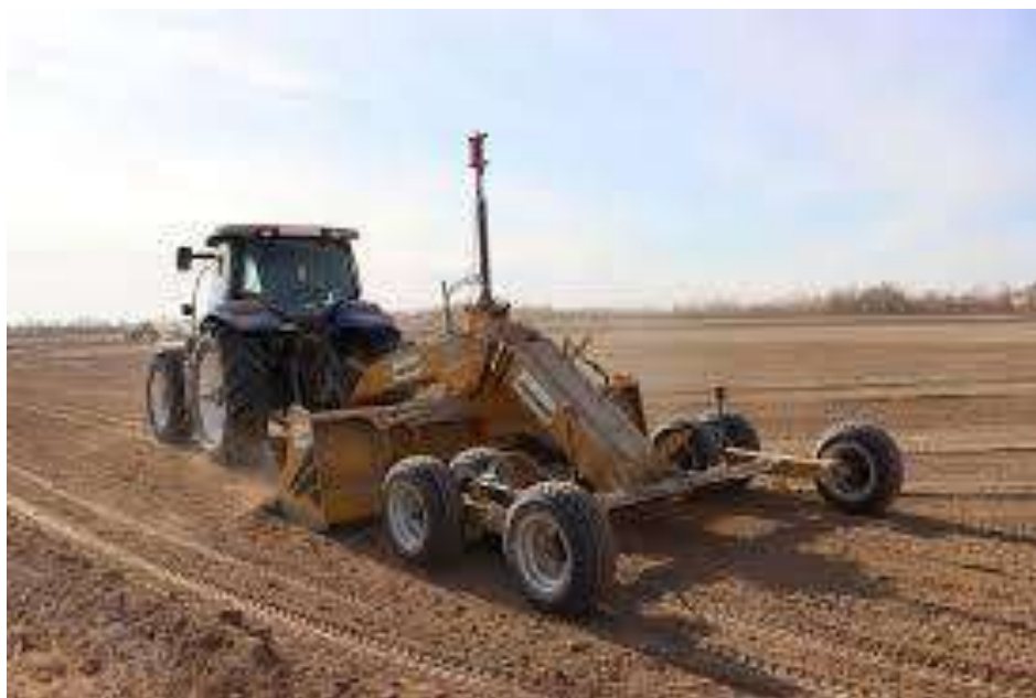
2-rasm. Greyder yordamida yerlarning relifini tekislash ishlari olib borilmoqda
