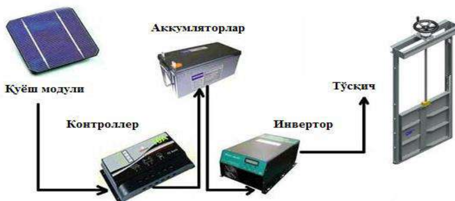
2-rasm. To'sqichni quyosh batareyasi bilan ta'minlash sxemasi.
