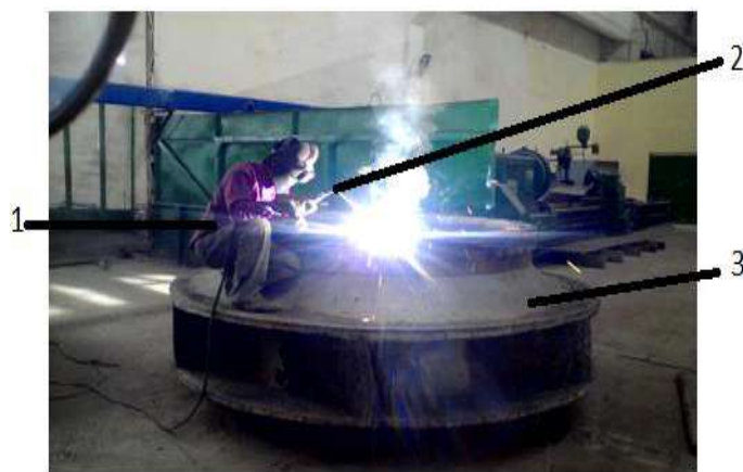
2-rasm. Nasos ishchi g'ildiragining kavitatsiya va gidroabraziv zarrachalar ta'sirida yeyilishi.
