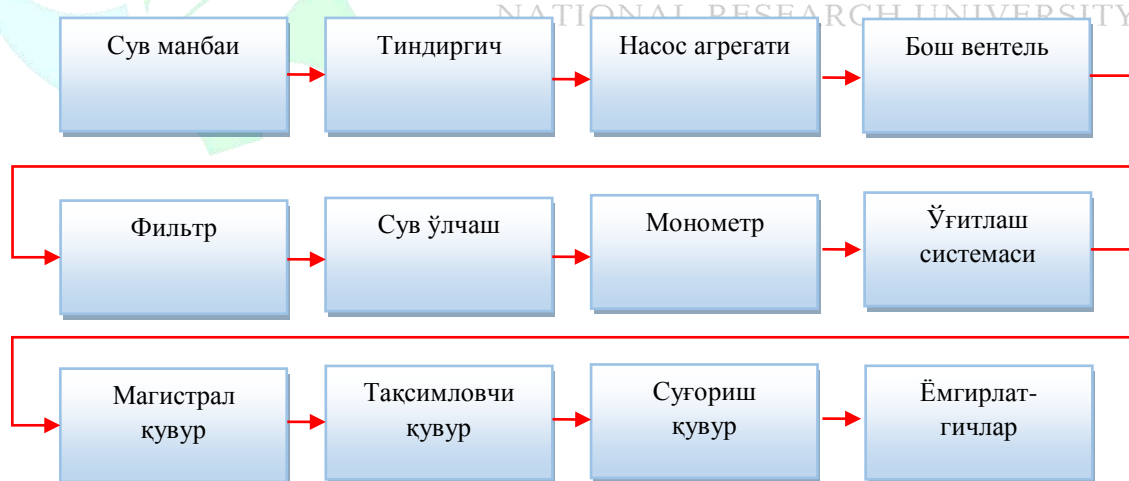
1-расм. СуВ тежамкор суғоришнинг умумий схема кўриниши
