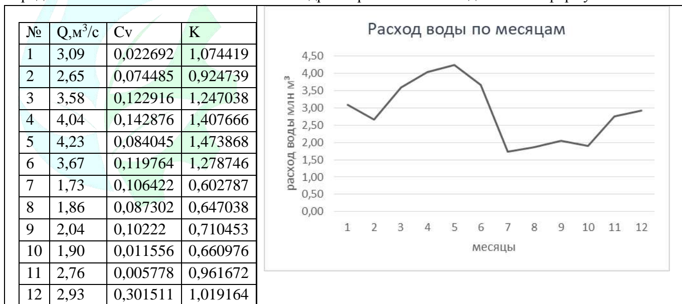
Рис.2 Расчетные гидрологические характеристики места строительства гидроэлектростанции
