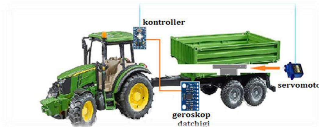
1-rasm. Traktor tirkamasining holatini avtomatik boshqarish tizimi uchun funksional-texnologik sxema.
