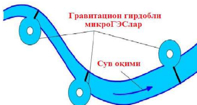
3-расм. Гравитацион гидробли микроГЭСларнинг каскад тизимли чизмаси.
