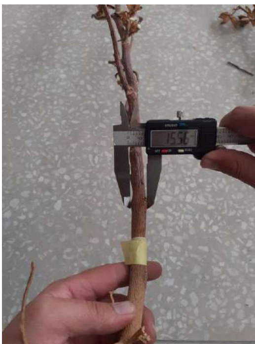
2-расм. Баландлиги бўйича ғўзапоя қаламчаларининг диаметрини электрон штангенциркульда ўлчаниши
