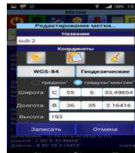
2-расм GPS тармоғига улаш ва нукта танлаш, нукта ҳосил қилиш қилиш
