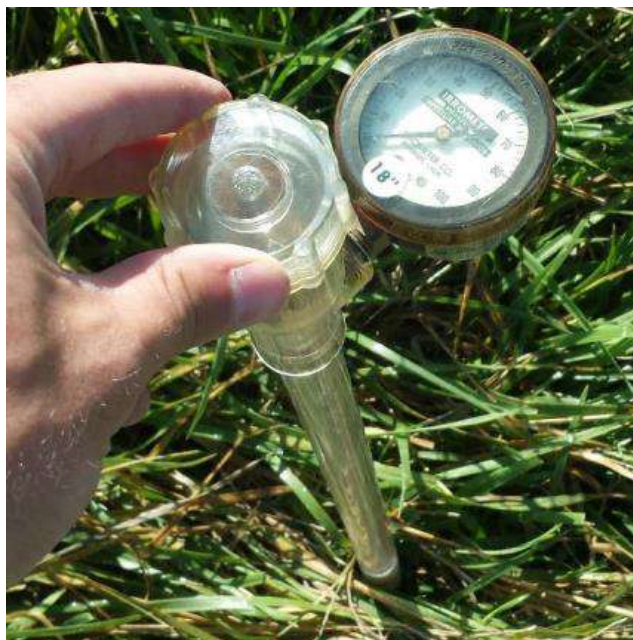
2 -rasm. Tuproqqa o'rnatiladigan g'ovakli chashka bilan tensiometrni o'rnatish (irrometr).
