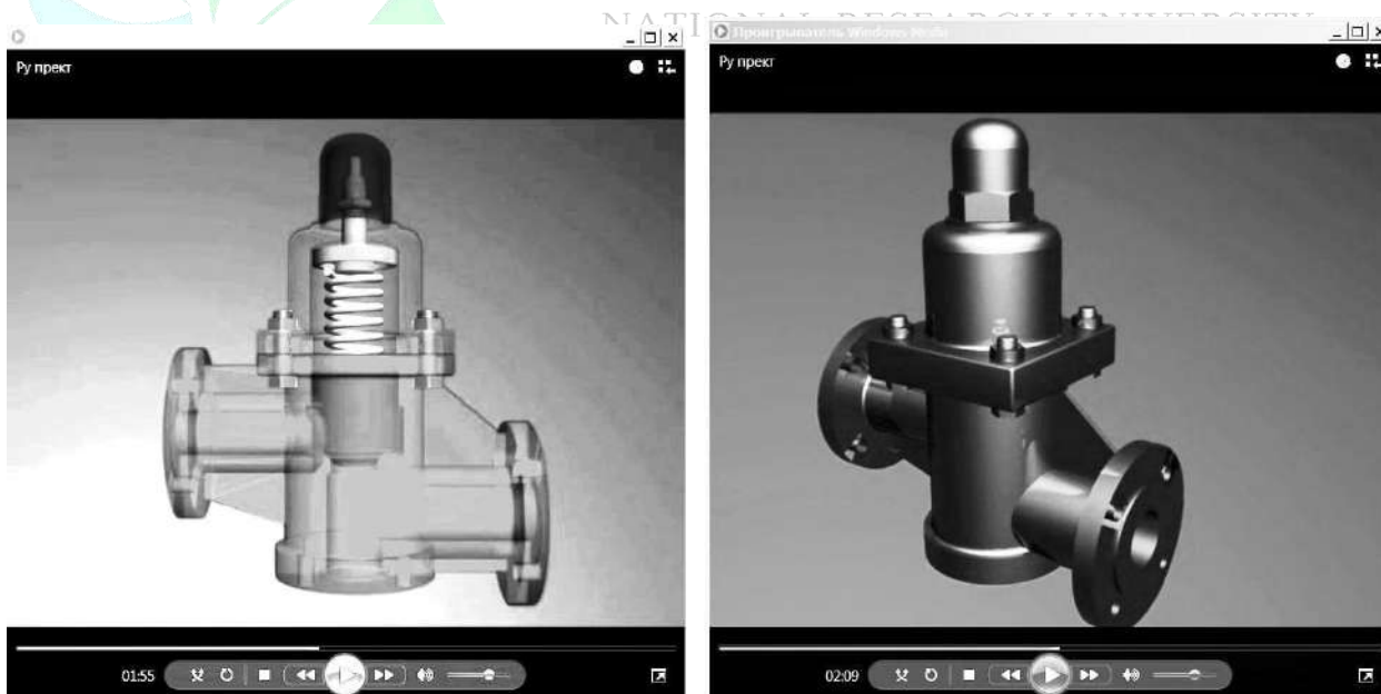
Фрагменты анимационного ролика по сборке перепускного клапана, созданного с помощью систем AutoCAD и 3D Max Studio
