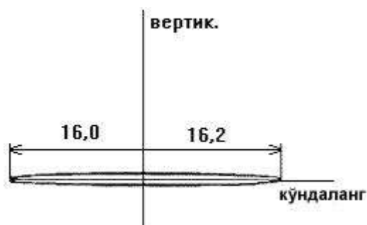
6-расм. 2-насос агрегати электр моторининг орқа podshipnigi tebranishi trayektoriyasi (siqilgan tayanch).
