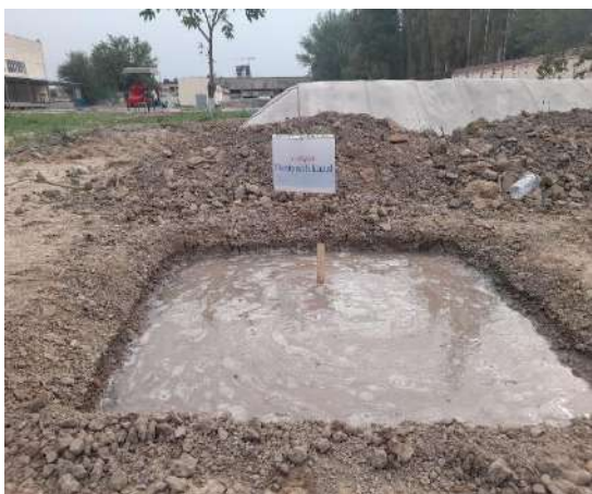
8-расм. Бентонитли каналда сувнинг сизилиши вақт бўйича рақамларда
