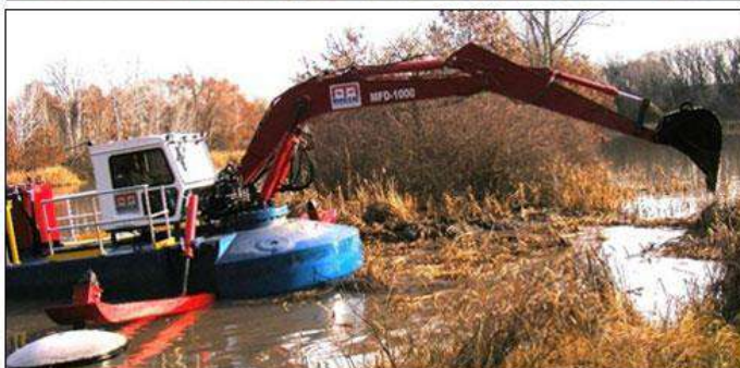
4,5 – расмлар. Қарши гидроузелида земснаряд ёрдамида ўзани тозалаш, универсал экскаватор
