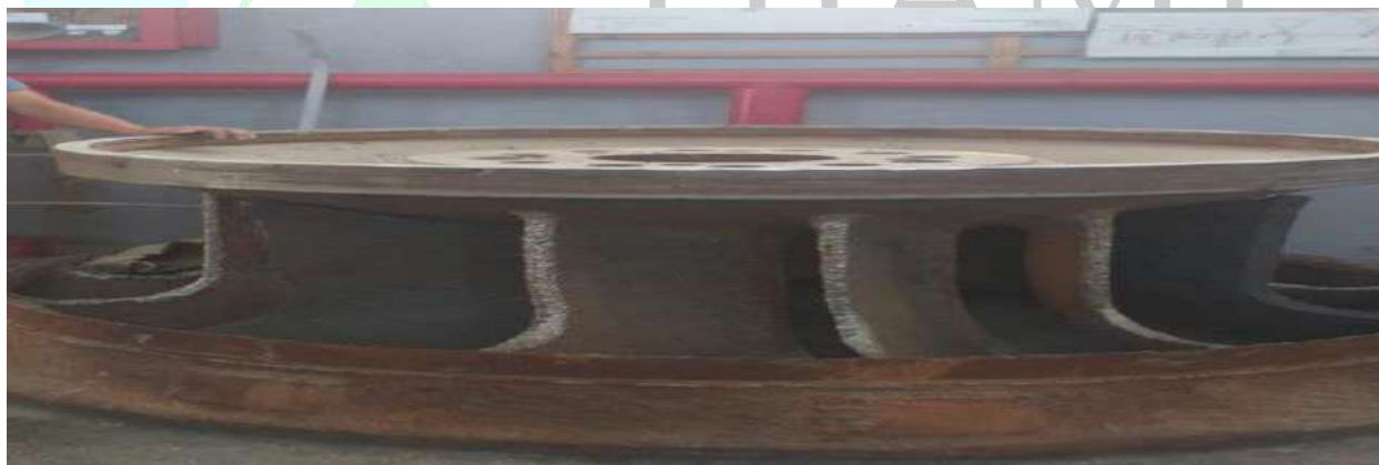
1-расм Турбина ғилдиракларининг емирилиши тасвирланган
