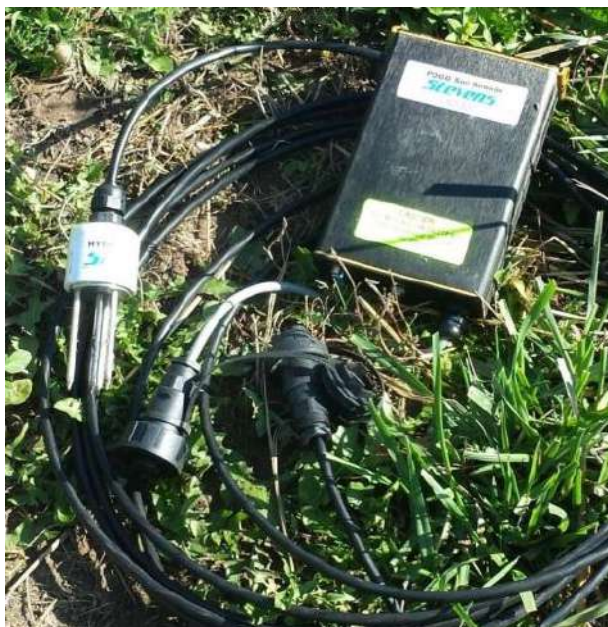
1-rasm. Tuproqning dielektrik xususiyatlari bo'yicha rele sensoriga misol
