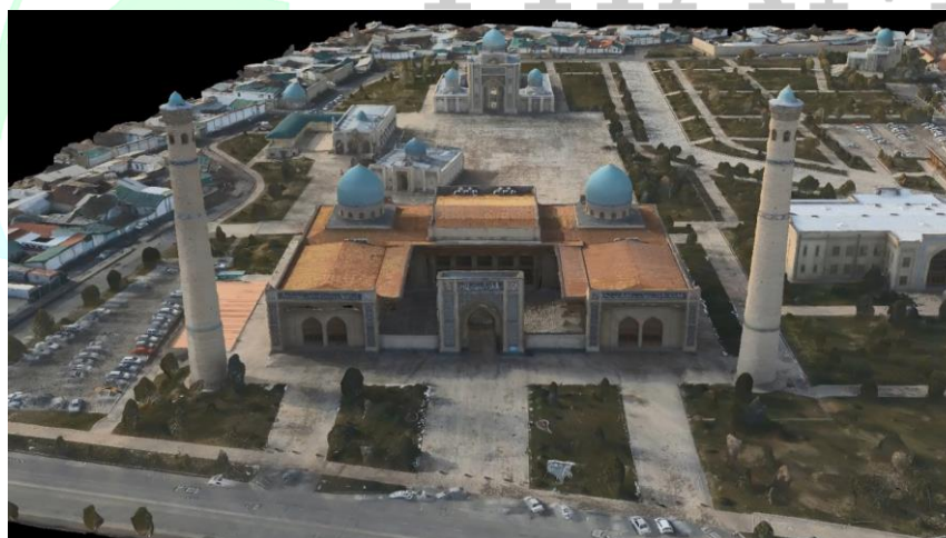
16-расм. Agisoft Metashape дастурида яратилган Ҳазрати Имом мажмуасининг уч ўлчамли моделининг олд юқоридан кўриниши
