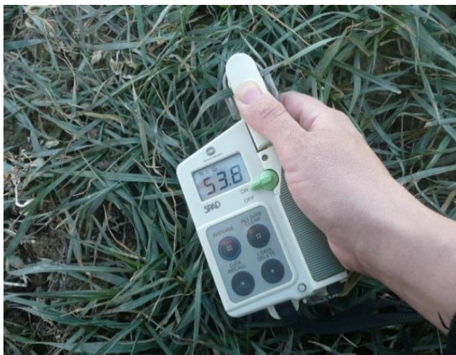
1-расм. Minolta SPAD-502 хлорофиллметр умумий кўриниши (чапда) ва барг киритилиб ўлчов бажарадиган қисми (унгда)
