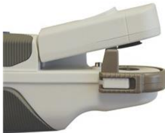
1-расм. Minolta SPAD-502 хлорофиллметр умумий кўриниши (чапда) ва барг киритилиб ўлчов бажарадиган қисми (унгда)
