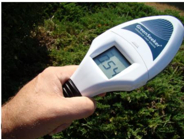
5-расм. GreenSeeker ўсимлик биомассасини аниқловчи партатив учкуна.
