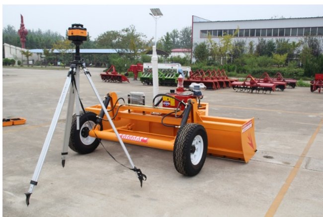
3-расм. Лазерли ер текислагич ва унинг қурилмалари
