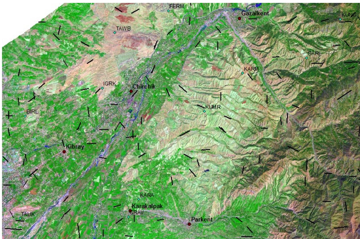
Рис. 2. Результат автоматизированной обработки данных Landsat 8 в программе LEFA
