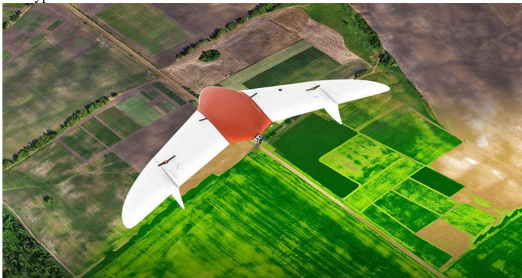
1-расм. Учувчисиз парвоз қилувчи “Geoscan 201” ёрдамида аэросуратга олиш.
