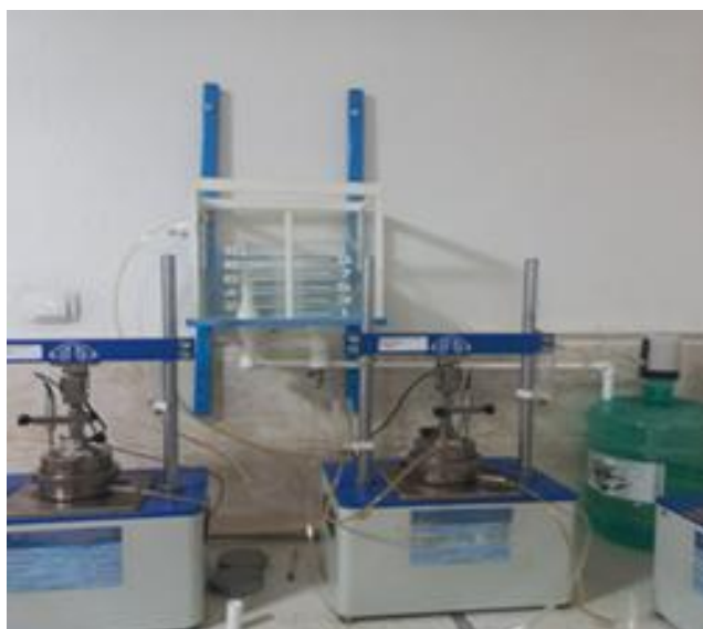
2.2-rasm. Gipsli grunt namunalarining filtratsiya va suffoziya jarayonlarini o‘rganish uchun mo‘ljallangan laboratoriya tajriba qurilmasining umumiy ko‘rinishi.
