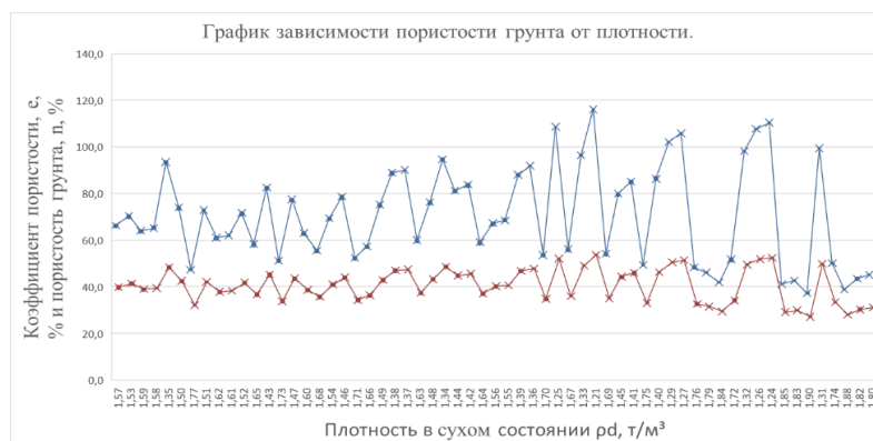
Рисунок 7. Зависимость пористости грунта от плотности в теле плотины.
