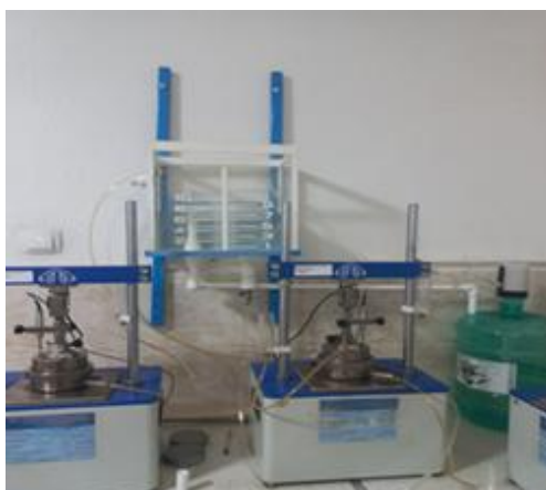
Рисунок 2.2. Общий вид лабораторной экспериментальной установки, предназначенной для изучения процессов фильтрации и суффозии в гипсоносных грунтах.
