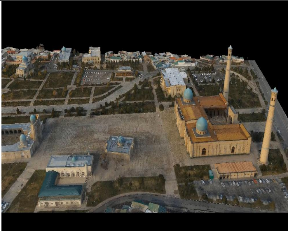
Рис.1 Трехмерная модель местности, созданная с помощью программного комплекса GEOSCAN -PHOTOSCAN
