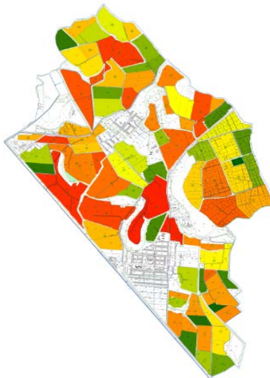
3-расм. Спектор ранглари асосида ер майдонларини суғориш даври визуаллаштирилган электрон рақамли харита
