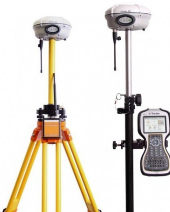
3.7-rasm. Trimble R8 GNSYS qabul qilgichi
