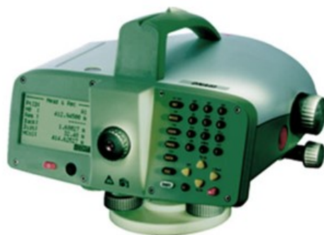
2.14-rasm. DNA 03 raqamli nivelir
