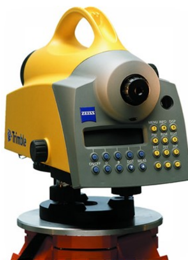
2.13-rasm. Dini 0.3 raqamli nivelir
