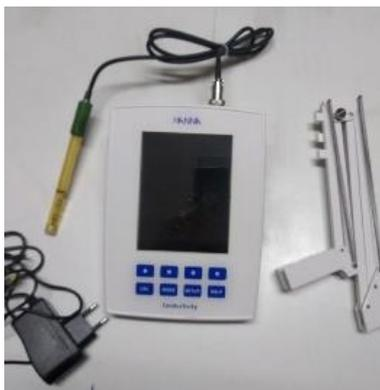
**Наименование лабораторного оборудования:** Кондуктомер стационарный
