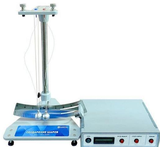
**Наименование лабораторного оборудования:** Лабораторная установка "Соударение шаров"
