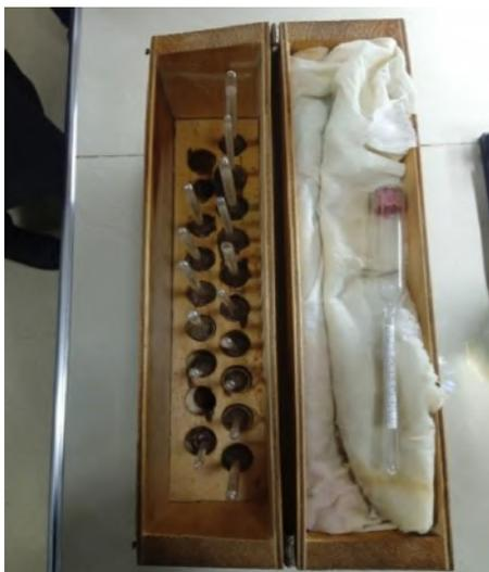
1. **Наименование лабораторного оборудования:** Ареометр АОН-1
