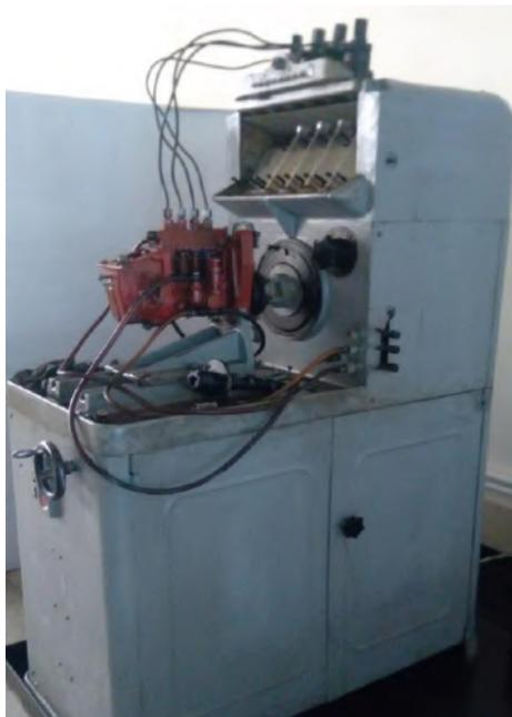
1. **Наименование лабораторного оборудования:** Стенд для проверки и регулировки ТНВД дизелей
