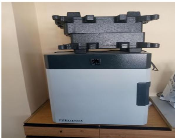
**Наименование лабораторного оборудования:** Сушильный шкаф
