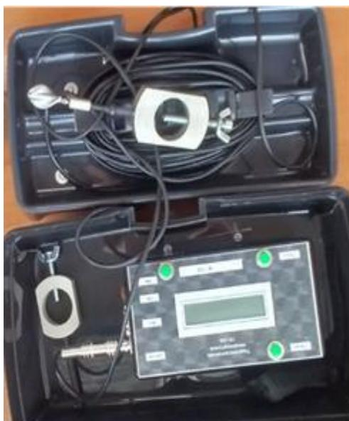
**Наименование лабораторного оборудования:** Измеритель скорости потока с регистратором (вертушка гидрометрическая)
