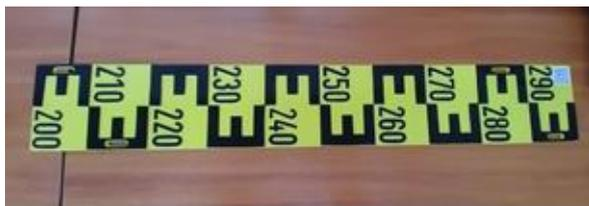
**Наименование лабораторного оборудования:** Водомерное рейка
