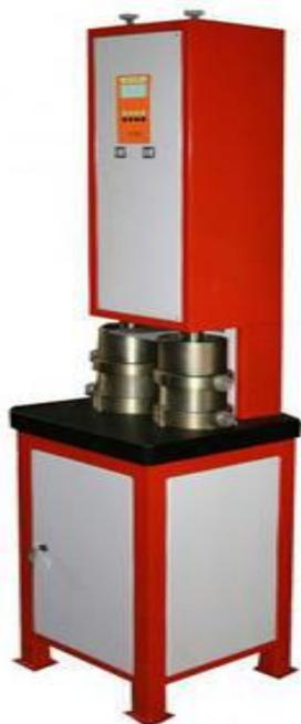
**Наименование лабораторного оборудования:** прибор стандартного уплотнения грунта ПСУ-МГ4
