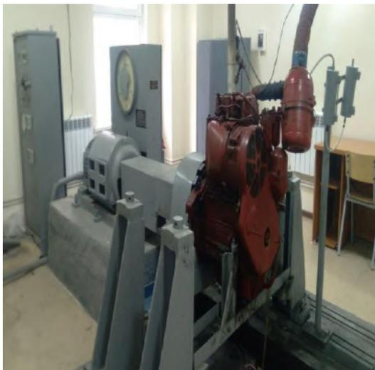
1. **Наименование лабораторного оборудования:** Стенд для испытания дизелей
