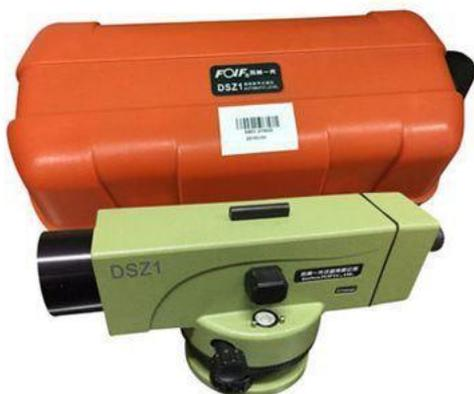
**Наименование лабораторного оборудования:** Оптические нивелир
