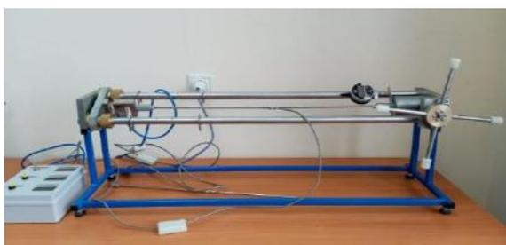
**Наименование лабораторного оборудования:** Типовой комплект учебного оборудования «Устойчивость продольно сжатого стержня» УСС-5ЛР-12
