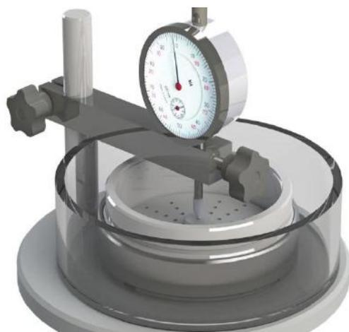
**Наименование лабораторного оборудования:** Прибор для определения набухаемости грунтов
