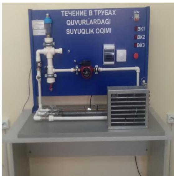
1. **Наименование лабораторного оборудования:** Лабораторное оборудование для испытаний трубчатых и пластинчатых теплообменников в трубопроводе
