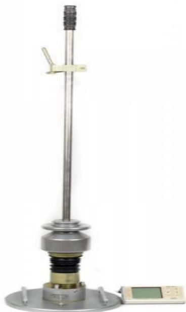
**Наименование лабораторного оборудования:** Измерители модуля упругости грунтов и оснований дорог ПДУ-МГ4 «Удар» и ПДУ-МГ4.01
