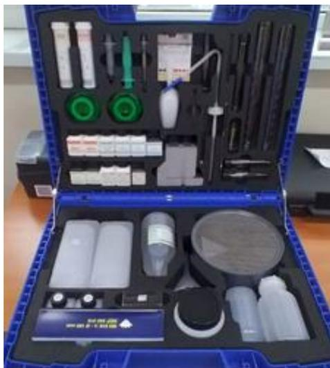
**Наименование лабораторного оборудования:** Набор для проверки состава воды.
