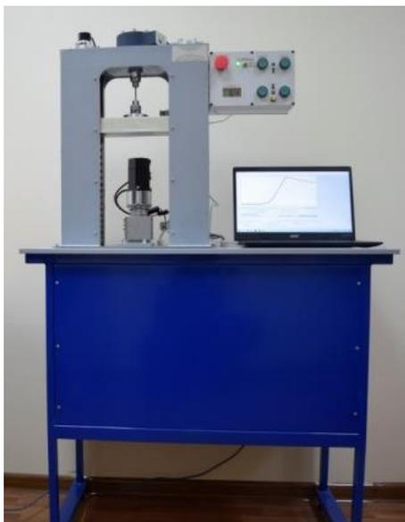
**Наименование лабораторного оборудования:** Учебная электромеханическая испытательная машина УЭИМ-20-300
