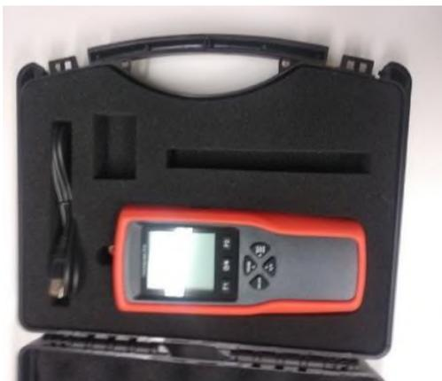
**Наименование лабораторного оборудования:** Термометр электронный
