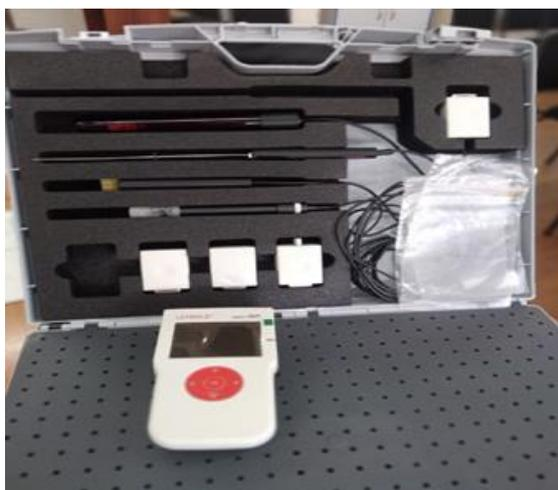
**Наименование лабораторного оборудования:** Набор для определения воды и влажности в почве.
