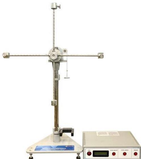
**Наименование лабораторного оборудования:** Лабораторная установка “Маятник Обербека”
