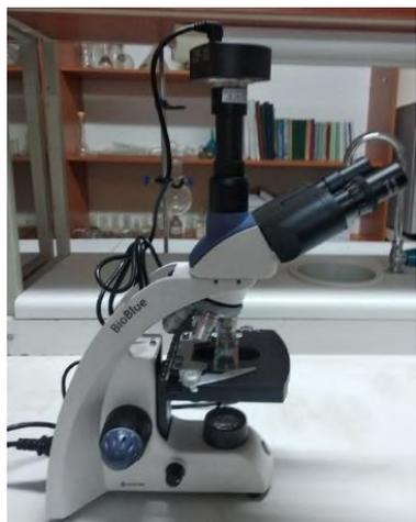
**Наименование лабораторного оборудования:** Цифровой микроскоп
