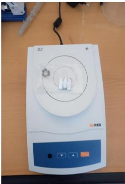
**Наименование лабораторного оборудования:** Магнитная мешалка с нагревательной плитой модель.
