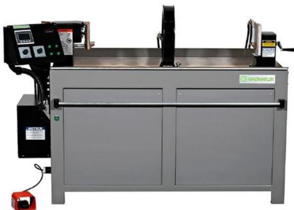
**Наименование лабораторного оборудования:** Магнитный дефектоскоп Д2060
