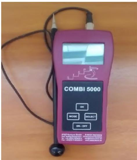
**Наименование лабораторного оборудования:** Измеритель влажности почвы
