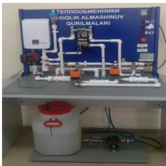
1. **Наименование лабораторного оборудования:** Лабораторная установка по изучению теплопередачи при течение жидкости в трубе
