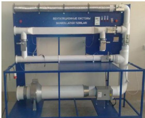
1. Наименование лабораторного оборудования: **Лабораторная установка для изучения вентиляционных систем**
