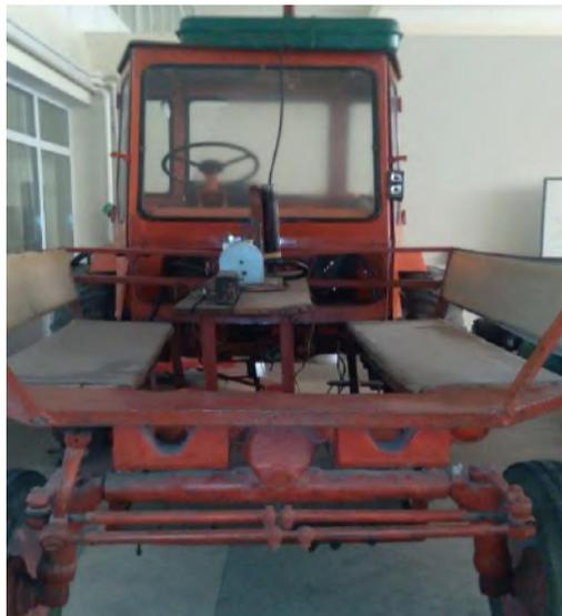
1. **Наименование лабораторного оборудования:** Устройство для проведения испытания трактора.
