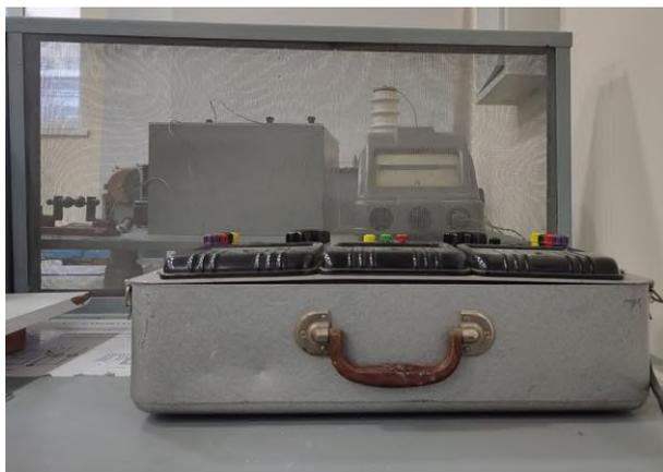
**Наименование лабораторного оборудования:** Определение электрической прочности диэлектриков, (определение электрической прочности трансформаторного масла)
