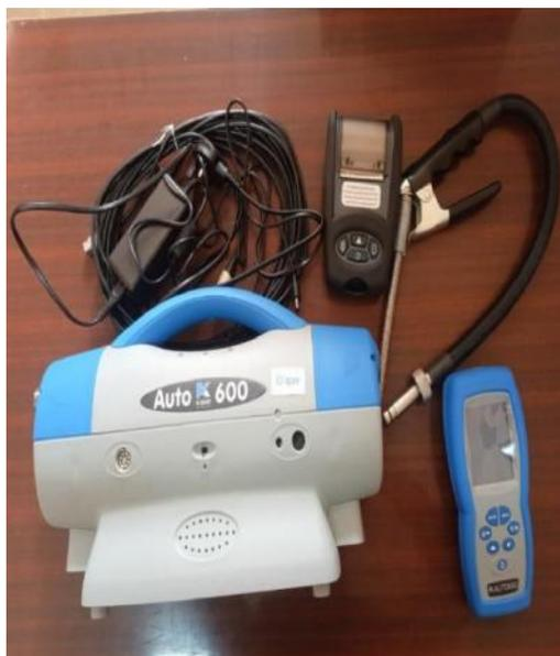
1. **Наименование лабораторного оборудования:** Прибор для изучения состава выхлопных двигателей тракторов и автомобилей
