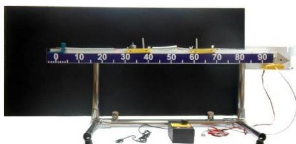
**Наименование лабораторного оборудования:** Лабораторная установка «Изучение механического резонанса»
