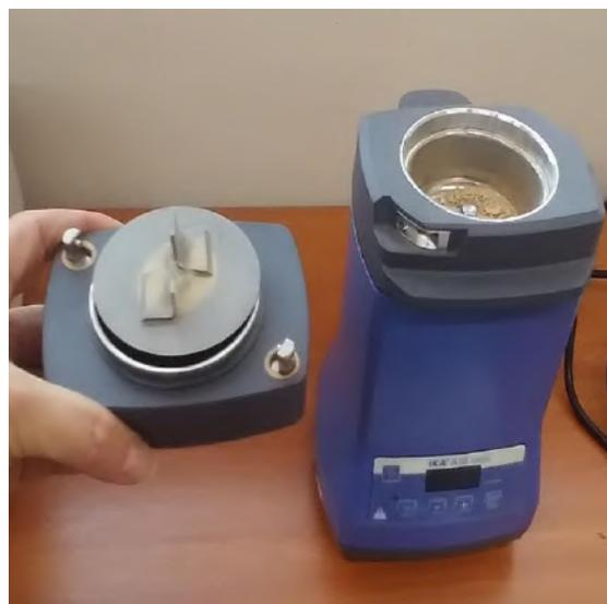
**Наименование лабораторного оборудования:** Лабораторная мельница.
