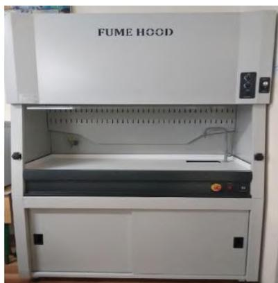
**Наименование лабораторного оборудования:** Вытяжной шкаф
