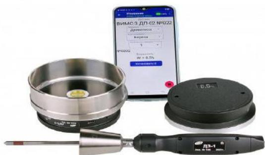
**Наименование лабораторного оборудования:** Устройства для определения влажности твердых и сыпучих грунтов.
