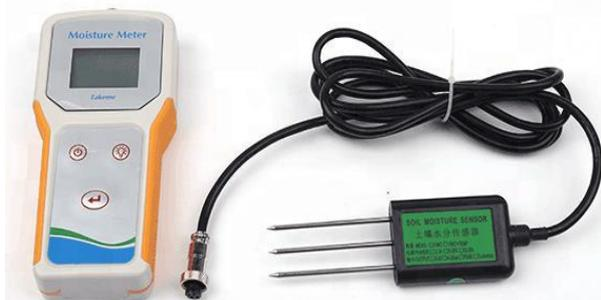
**Наименование лабораторного оборудования:** Прибор для измерения влажности и температуры почвы
