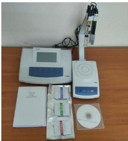
**Наименование лабораторного оборудования:** Иономер
