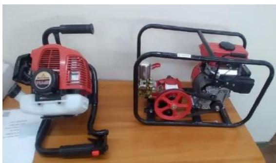
**Наименование лабораторного оборудования:** Портативная буровая установка.
