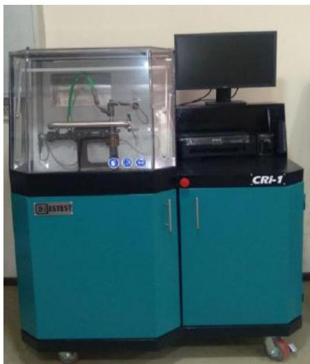
1. **Наименование лабораторного оборудования:** Стенд для проверки инжекторов топливной системы Common Rail
