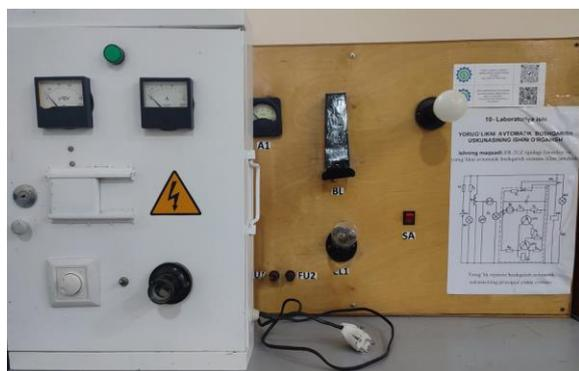
**Наименование лабораторного оборудования:** Исследование работы установки для автоматического управления световым режимом
