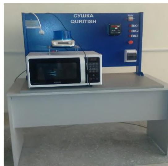
1. **Наименование лабораторного оборудования:** Лабораторный прибор для изучения различных способов сушки материалов
