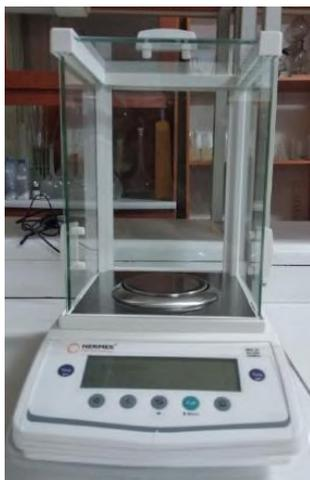
**Наименование лабораторного оборудования:** Весы аналитические
