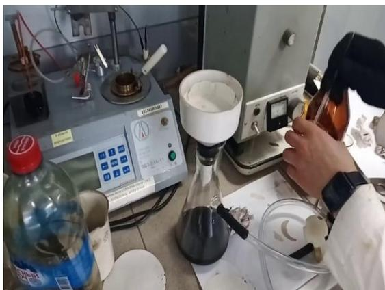
1. **Наименование лабораторного оборудования:** Прибор для определения механического примеси
