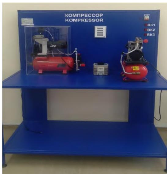
1. Наименование лабораторного оборудования: **Лабораторный прибор для изучения принципа работы поршневого компрессора**
