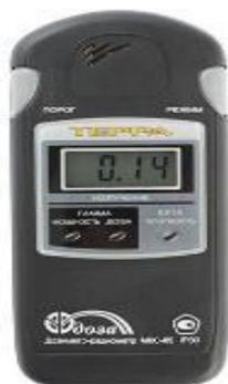
**Название прибора:** Радацинный дозиметр
